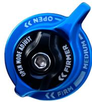
FIT4-Compression-Einstellhebel & Open Mode Adjust
