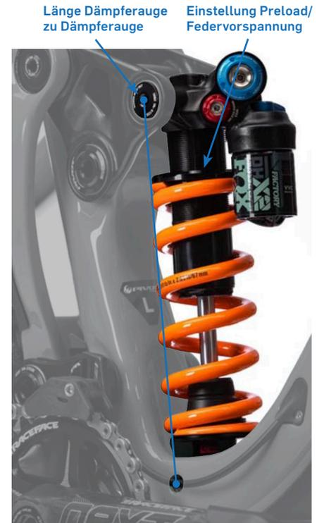
Die ab Werk ausgerüsteten Federraten passen für den durchschnittlichen Fahrer je Rahmengröße, wer etwas neben dem Durchschnitt liegt wird eine härtere oder weichere Feder benötigen, um 30 % Sag zu erzielen. In der unten stehenden Tabelle sind Empfehlungen für verschiedene Fahrergewichte und Federlängen und Hub-Varianten angegeben, die für Fox- und Marzocchi-Dämpfer im Mach 6 passen.
