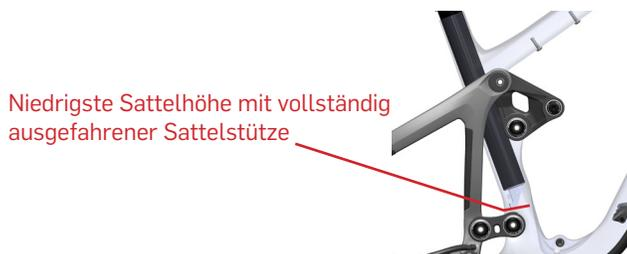
Niedrigste Sattelhöhe mit vollständig ausgefahrener Sattelstütze
