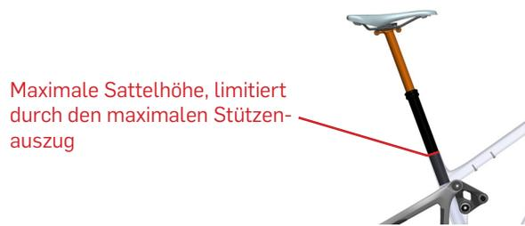
Maximale Sattelhöhe, limitiert durch den maximalen Stützensauszug
